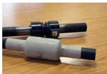
Virolas recubiertas con Belzona
